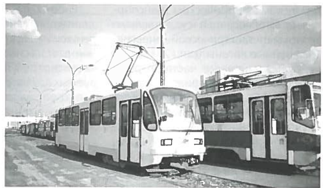
Рис. 2. Трамвайные вагоны с частотно-регулируемым электроприводом переменного тока
