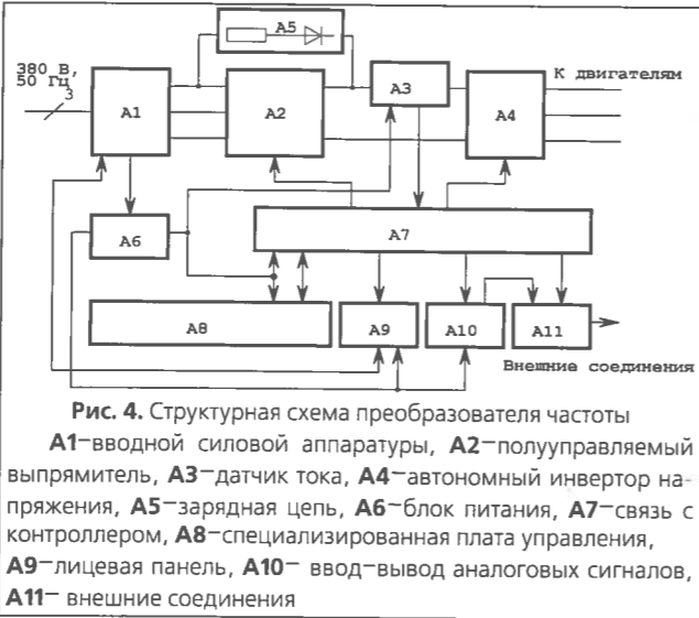
Рис. 4. Структурная схема преобразователя частоты
